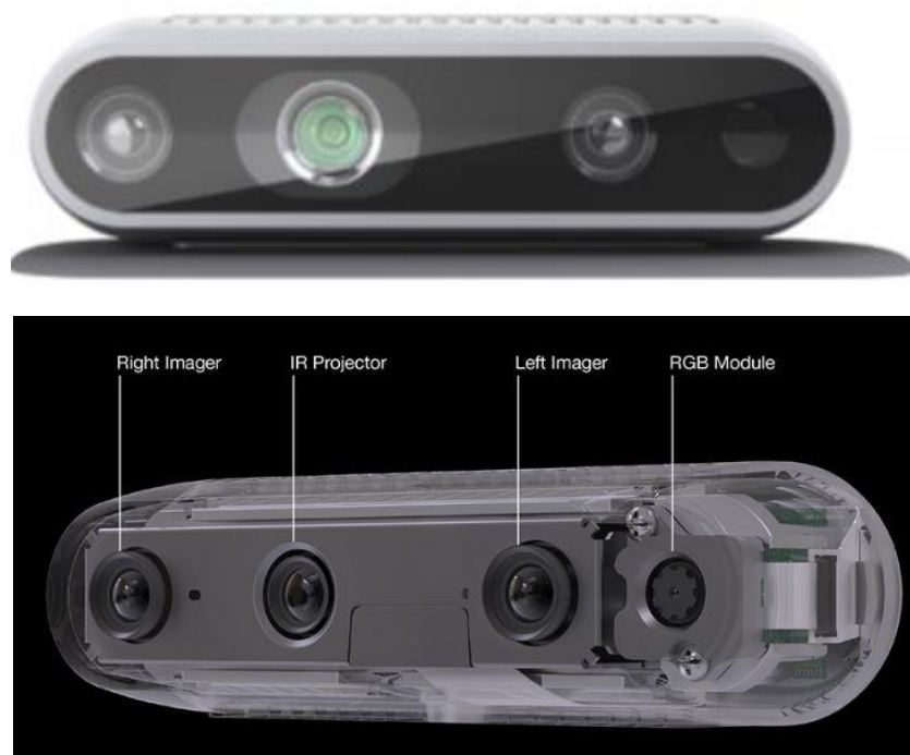
Figur 1 - Intel RealSense Dybdekamera D435i. [Bilde: Intel].
